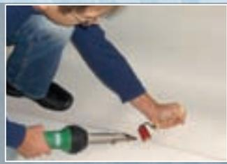
RiOn适用于所有热塑性材料的焊接，广泛使用在土工建筑施工，屋面防水，塑料制造，汽车维修，地板铺装等行业。
