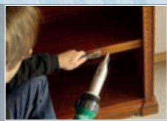
温度可无级调节,最高可达650 °C,功能强大,符合人体工学设计的操作手柄可应用在不同的场合如:烘干、热收缩、锡焊、加热、焊接等,配套整系列的风嘴选择。
